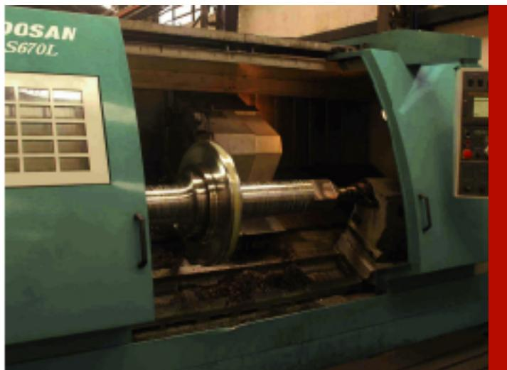
Ejes fundidos en acero de excelentes propiedades mecánicas, que pueden reemplazar a los productos forjados. Recomendados para el clavado de anillos de laminación, en la fabricación de perfiles. Es de destacar el abaratamiento de costos de laminado, ya que al ser armados de esta forma, se recambia únicamente el rodillo, y el eje se sigue utilizando. Dado que el peso del eje representa aproximadamente el 80% del peso del conjunto, nos da una idea del ahorro que puede lograrse.
